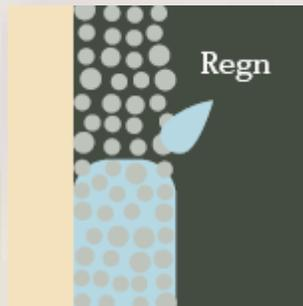
A través de un microscopio podemos ver cómo la lluvia penetra a través del repello, entre las diferentes partículas de arena.
