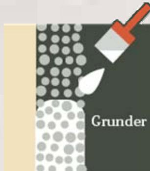
Se cubre la superficie con un tratamiento de silicato de Sodio que se petrifica con las partículas minerales de la fachada.
